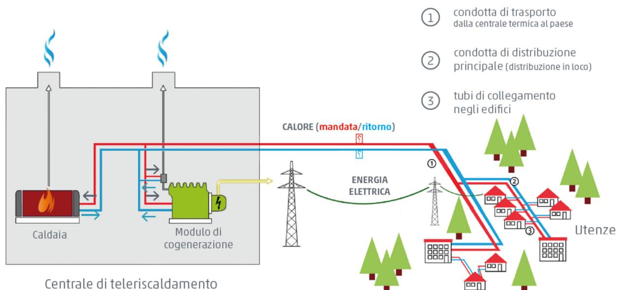
L'energia elettrica prodotta viene immessa nella rete elettrica locale, mentre il calore viene immesso nella rete di distribuzione calore che raggiunge il singolo utente secondo le modalità dello schema.
