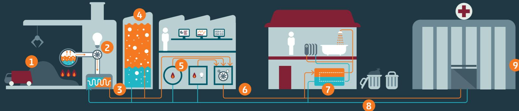
Nel termovalorizzatore dei rifiuti solidi urbani con gli scarti si produce calore (1). Il vapore prodotto dalla combustione aziona una turbina (2) per la produzione di energia elettrica. Il calore residuo (3) viene utilizzato dalla centrale di teleriscaldamento Alperia. Dalla centrale di teleriscaldamento Alperia risponde alla richiesta di
