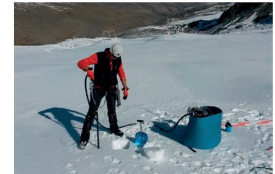
Messungen im Eis des Schnalstaler Gletschers, der den Stausee Vernagt und das Wasserkraftwerk Naturns speist. Kenntnisse zur Voraussage der Auswirkungen der Schneeschmelze sind wichtig, um Vorhersagemodelle zu erstellen, die Alperia bei der Optimierung der Energieproduktion unterstützen und um auf dem Energiemarkt agieren zu können.
